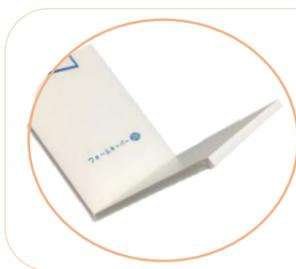
**ポリプロピレン中空板製**です。折り曲げ部は熱溶着しているので強固です。端面は熱処理にて目ふさぎをしているのでゴミや水の侵入を防ぎます。
