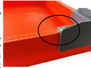
コーナー部と 熱フレームに段差なし
