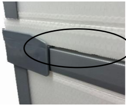
段積みの際 隙間が生まれ 帯電防止効果も 連続性がなくなります。
